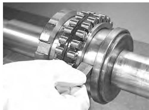
Рис. 1.15 Измерение ширины дистанционного кольца
