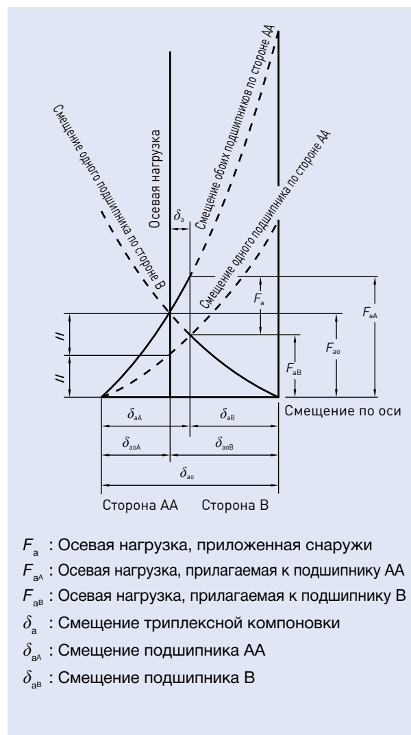
Рис. 4.6 Смещение по оси компоновки DBD с преднатягом
