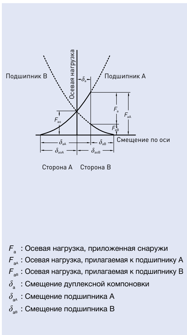
Рис. 4.4 Смещение по оси компоновки DB с преднатягом
