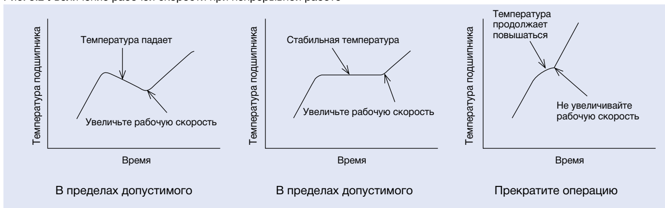
Рис. 3.2 Увеличение рабочей скорости при непрерывной работе
