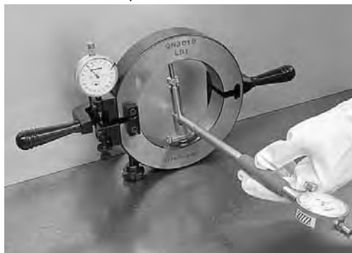
Рис. 1.11 Регулировка вписанного диаметра калибра GN
