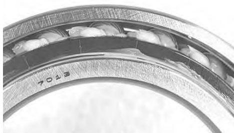
Рис. 1.20 Наполненный смазкой цилиндрический роликовый подшипник
