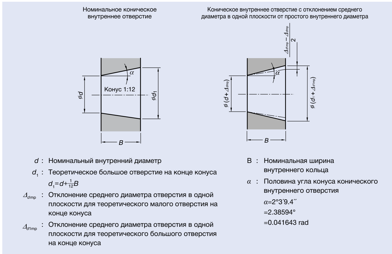
Рис. 7.3 Допустимые отклонения конического внутреннего отверстия
