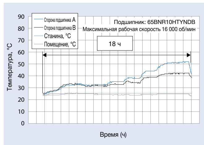
Рис. 3.1 Изменения температуры при работе с постоянной скоростью
