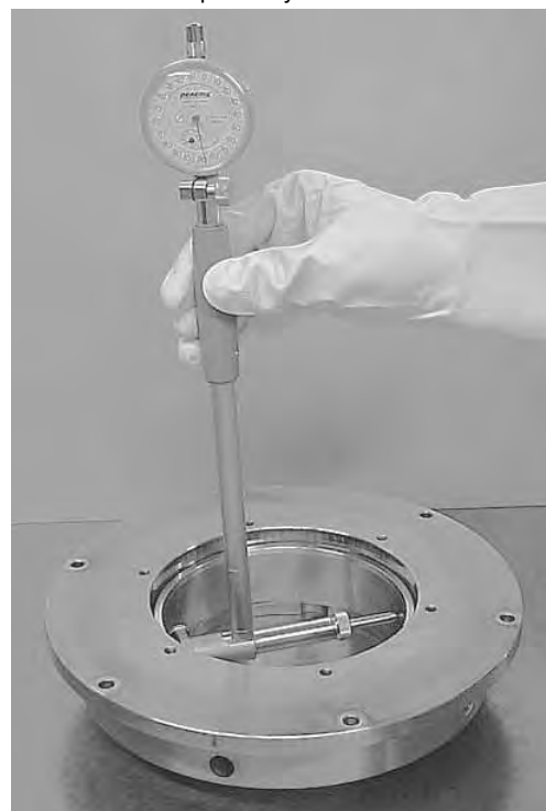
Рис. 1.11 Регулировка вписанного диаметра калибра GN
