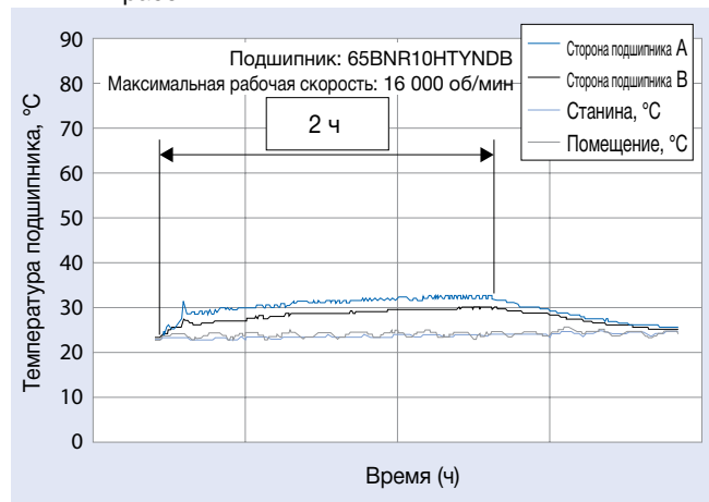
Рис. 3.3 Изменение температуры при прерывистом режиме работы
