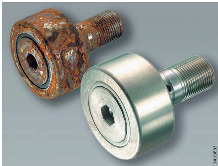
Рисунок 25 Опорный ролик с цапфой с защитным покрытием и без после испытания в солевом тумане
